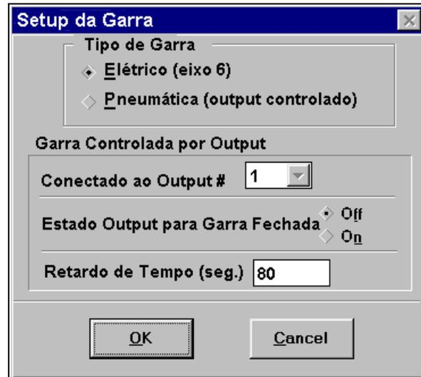
Você pode selecionar uma garra elétrica (eixo 6) ou uma garra pneumática (com output controlado).
