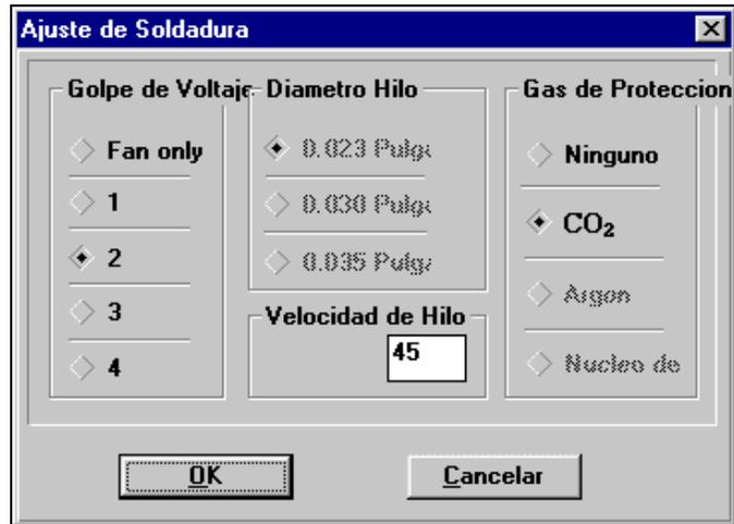
Los parámetros por defecto son definidos según la recomendación de Millermatic (vea el Manual de Usuario de Millermatic). Algunos parámetros no son independientes. Por ejemplo, al cambiar el golpe de voltaje, la velocidad del hilo cambia automáticamente. Observe que la velocidad puede ser cambiada sin cambiar el golpe de voltaje.
